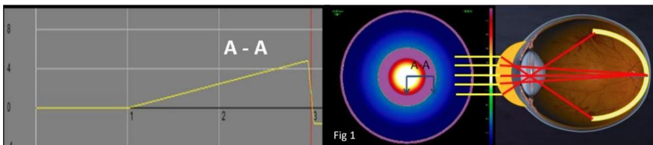
Конструкция МіОрія Торік представляет собой заднюю торическую поверхность с призматическим балластом, с гравированной контрольной меткой на 270°.
